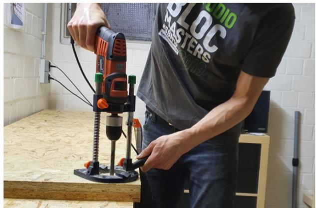
Bild 18: Bohren der Löcher in zugeschnittene OSB-Platten
