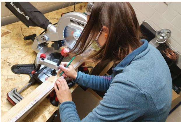
Bild 5: Ablängen der Wandbalken mit der Kappsäge
